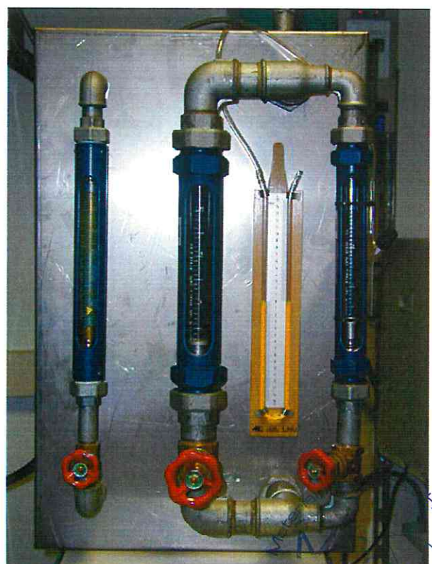
Bild 3b: Prüfstand-Steuerung (Wasser- u. Luftmenge)
