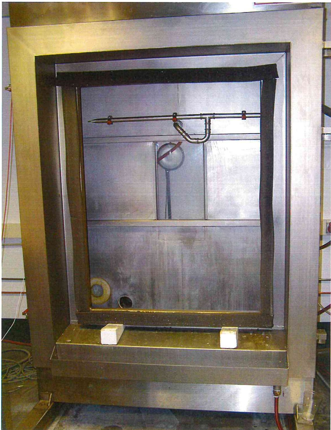
Bild 1: Offener Prüfstand ohne den eingesetzten Versuchskörper
