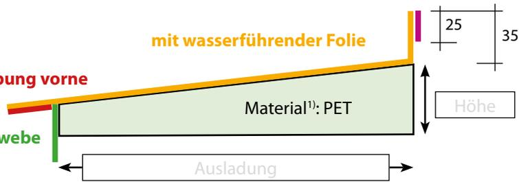
Selbstklebung Sohlbank ist Standard 25 mm (Aufkantung 35 mm)
